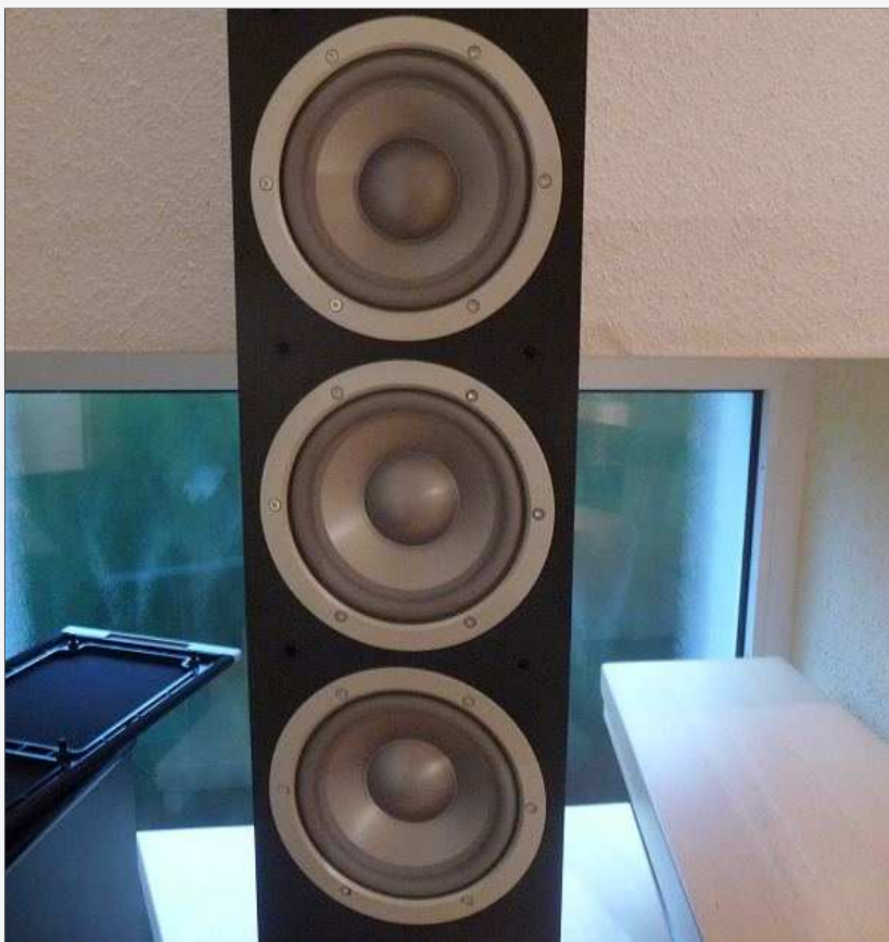
Drei Basschassis bei der C 336. Auf der Rückseite befindet sich die Bassreflexöffnung
